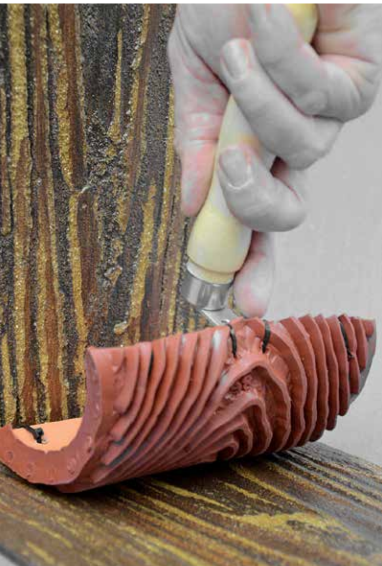
Ukázka fládrovacího nářadí: fládrovací kolíbka a válečky.
